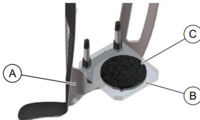
2. Coloque la plataforma de impresión dental <sup>(B)</sup> sobre el soporte del bloque de mordida 3D <sup>(A)</sup>.
